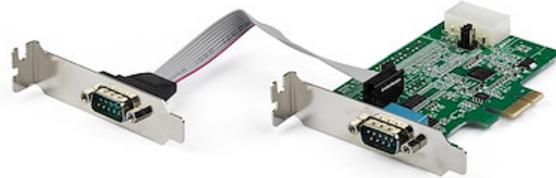
Esta tarjeta adaptadora serie RS232 le permite agregar a su ordenador dos puertos serie RS232 (DB9), a través de una ranura PCI Express (PCIe). Le permite interactuar con dispositivos serie, como lectores de tarjetas, impresoras, terminales PIN Pad o módems, a velocidades de hasta 921,4Kbps.
