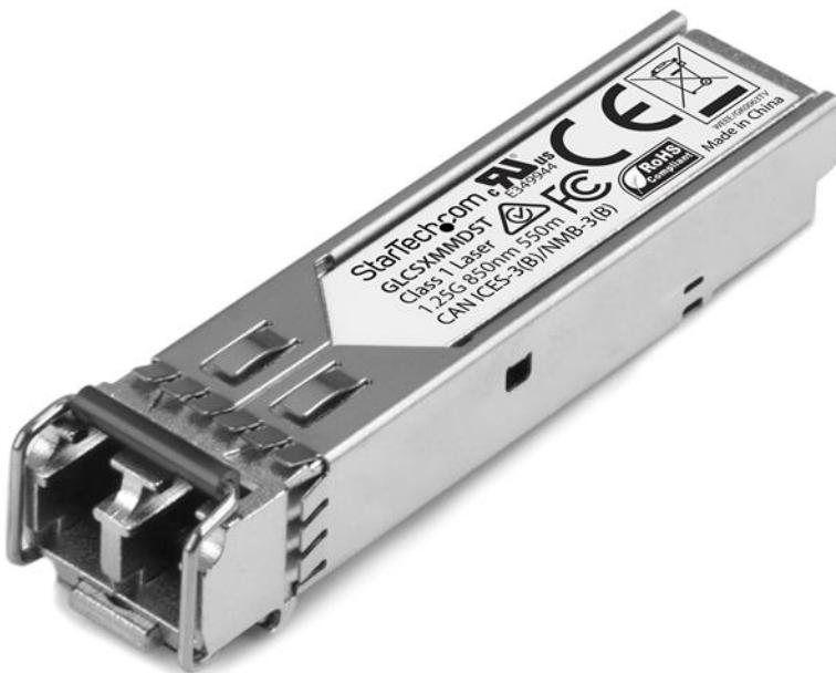
El modelo GLCSXMMDS es un módulo transceptor por fibra óptica compatible con el modelo GLC-SX-MMD de Cisco, diseñado, programado y probado para su funcionamiento con enrutadores y conmutadores de la marca Cisco®. Ofrece conectividad fiable a 1GbE a través de cableado de fibra, para redes compatibles con 1000BASE-SX, a una distancia máxima de hasta 550m.
