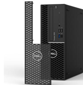
STAUBFILTER FÜR PRECISION-KOMPAKTGEHÄUSE
