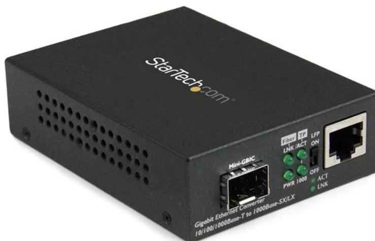
Il convertitore multimediale in fibra offre un modo facile e conveniente di estendere la propria rete su fibra, utilizzando l'SFP scelto. Converte una connessione Ethernet RJ45 in rame in fibra Gigabit, per estendere la rete su lunghe distanze o collegare le workstation agli switch. Il convertitore fornisce una potente soluzione di rete per campus universitari, aziende, strutture pubbliche, stadi e altre aree che necessitano di accesso alla rete.
