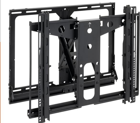
Das PFW 6880 ist ein flaches Videowand-Popout-Modul mit einem Abstand zwischen Bildschirm und Wand von nur 50 mm. Es verfügt über eine federbelastete Drucktaste zur Öffnungsfreigabe durch leichtes Drücken auf den Bildschirm.
