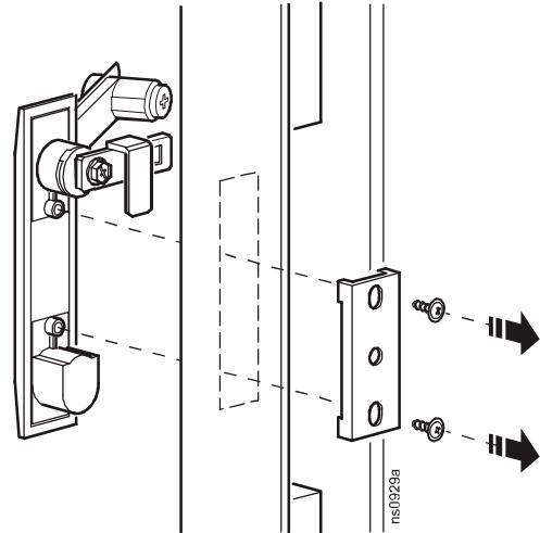
2. Entfernen Sie Schraube, Nocken und Unterlegscheibe von der Rückseite des Türgriffs. Drehen Sie die Unterlegscheibe um 90° gegen den Uhrzeigersinn und den Nocken um 180° gegen den Uhrzeigersinn.
