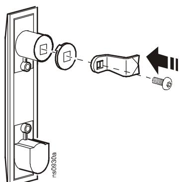
**So montieren Sie den Türgriff in umgekehrter Einbauposition:** Wenn Sie die Tür in umgekehrter Einbauposition anbringen, müssen Sie die folgenden Schritte durchführen, um den Türgriff richtig auszurichten.
