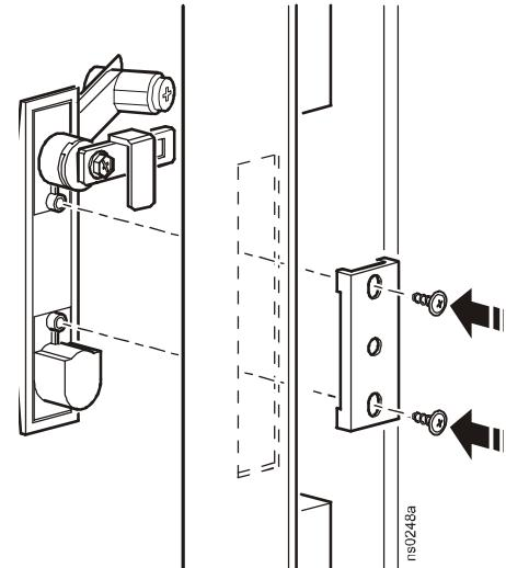
**So tauschen Sie den Nocken aus:** Wenn Sie ein NetShelter VX Rack haben, ersetzen Sie den vorinstallierten NetShelter SX Nocken mit dem NetShelter VX Nocken (mitgeliefert).
