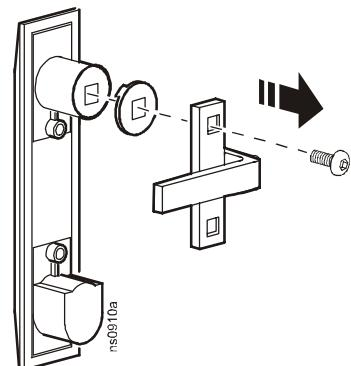
2. Ersetzen Sie den NetShelter SX Nocken mit dem NetShelter VX Nocken, und sichern Sie ihn mit der im vorherigen Schritt entfernten Schraube.
