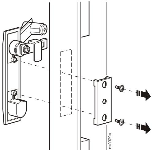
**So installieren Sie das Kombinationsschloss:**
