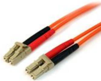
El cable de fibra óptica (2 m), categoría LSZH, LC a LC, modelo 50FIBLCLC2, con fibra óptica de 50/125 micrones para alta velocidad, proporciona transmisiones de datos a alto ancho de banda a través de redes Gigabit Ethernet y canal de fibra, con soporte para aplicaciones dúplex multimodo.
