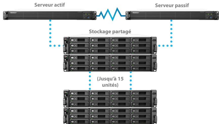
Le RXD1215sas connecté se comporte comme la réserve de stockage des deux serveurs, de sorte qu'aucune réplication des données n'est nécessaire, ce qui économise davantage d'énergie et d'espace de rack. Il est possible d'augmenter la capacité de stockage en ajoutant davantage de RXD1215sas (jusqu'à 15) dans le cluster HA, ce qui offre une évolutivité jusqu'à 180 disques durs et une capacité brute maximale supérieure à 1 pétaoctet.
