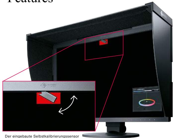
Der eingebaute Selbstkalibrierungssensor klappt sich bei Gebrauch selbstständig aus
