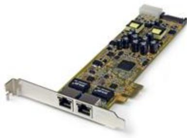
NIC PoE a due porte ST2000PEXPSE offre due porte RJ45 poE 10/100/1000 Mbps in grado di fornire un'alimentazione da 25,5 W ciascuna combinando una connessione dati di rete e l'alimentazione su un unico cavo per un minore ingombro e comode installazioni in postazioni remote.
