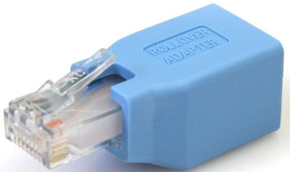
L'adattatore cavo console Cisco di lunga durata è una soluzione compatta per convertire un cavo Ethernet in uno rollover (cavo console Cisco®). L'adattatore è conforme allo standard Yost per il collegamento in serie di dispositivi e prevede garanzia a vita StarTech.com.
