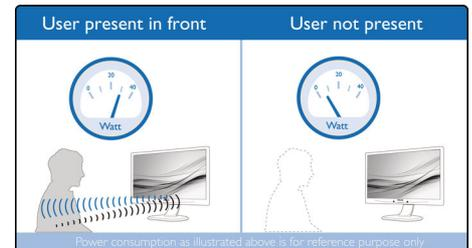
PowerSensor est un « détecteur de présence » intégré qui transmet et reçoit des signaux infrarouges sans danger lorsque l'utilisateur est présent et réduit automatiquement la luminosité du moniteur lorsque l'utilisateur s'éloigne du bureau. Il permet ainsi de diminuer de 80 % la consommation d'énergie et de prolonger la durée de vie du moniteur.
