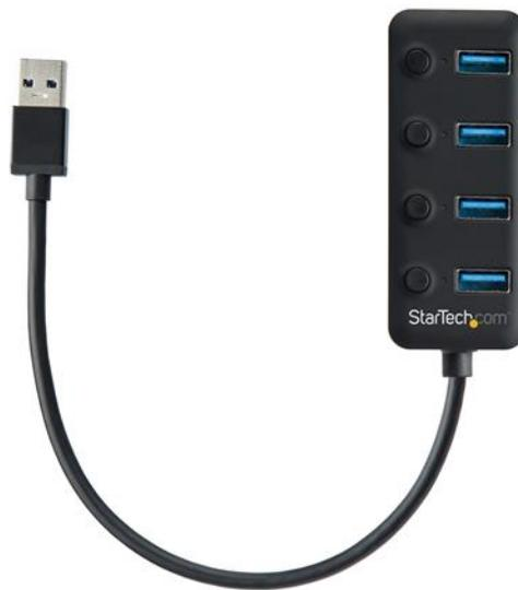
Este concentrador portátil USB 3.0 constituye una forma sencilla de agregar cuatro puertos USB 3.0 Type-A a su ordenador portátil, con interruptores individuales de encendido para ahorrar energía. El expansor de puertos USB se conecta fácilmente al puerto USB Type-A de su ordenador portátil. Además, incluye alimentación por bus que facilita la portabilidad.
