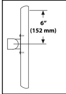
Bei der Bestimmung der Montagehöhe wird von einem Abstand von 152 mm (6") zwischen der Mitte der Montagemöcher und der Oberkante des Bildschirms ausgegangen. Wenn der tatsächliche Abstand kleiner ist, sollten Sie die Montagehöhe entsprechend vergrößern; wenn er größer ist, sollten Sie ihn entsprechend verringern.
