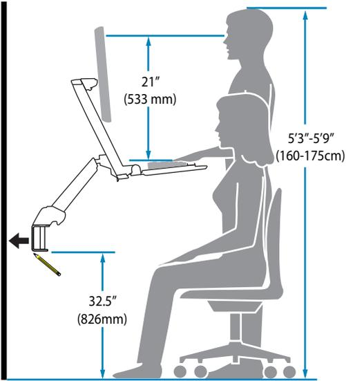
Diese Montagehöhe wird für einen ergonomischen Arbeitsplatz empfohlen, der für Benutzer mit einer Körpergröße zwischen 5'3"-5'9" (160-175cm) geeignet ist.
