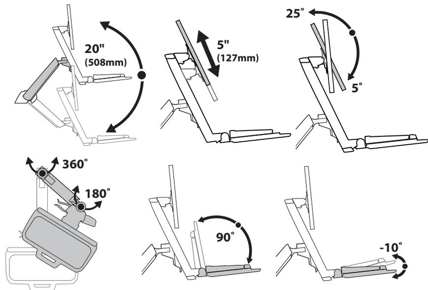
\* Der Combo Arm kann so angepasst werden, dass er Bildschirme mit einem Gewicht von bis zu 11,3 kg (25 lbs) unterstützt. In diesem Fall stehen die Optionen zum Heben und Neigen des Bildschirms jedoch nicht zur Verfügung. Weitere Informationen hierzu finden Sie auf Seite 8.
