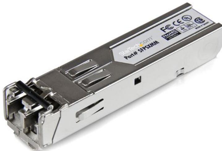
El transceptor de fibra óptica multimodo SFP Gigabit 850 nm, LC 550 m SFPSXMM , está fabricado para ajustarse a las normas MSA ("Multi-Sourcing Agreement", acuerdo multifuente) y es una alternativa económica para mejor rendimiento y conectividad con los dispositivos de red conectados mediante fibra óptica.
