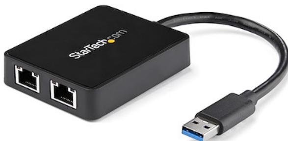
L'adattatore USB 3.0 a doppia porta Ethernet Gigabit USB32000SPT consente di aggiungere due porte Ethernet Gigabit al laptop o al computer Ultrabook™ tramite una singola porta USB 3.0, inoltre vanta una porta USB pass-through 3.0 che mantiene libera la porta USB per l'utilizzo di un dispositivo di archiviazione esterno o altre periferiche. Ogni porta RJ45 supporta una rete Ethernet 10/100/1000 Mbps ed è interamente compatibile con gli standard 802.3i/u/ab.
