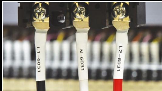
Der nicht-klebende Schlauch ist aus einem speziellen Material hergestellt, der flach zusammengefaltet in der Bandkassette aufgerollt ist. Nach dem Druck wird der Schlauch geöffnet und über ein Kabel oder einen Abschlussstecker gezogen. Bei entsprechender Heizeinwirkung mittels eines Heißluftgerätes, schrumpft das HSe Pro Tape auf bis zu ein Drittel seiner ursprünglichen Breite und umschließt das Kabel.
