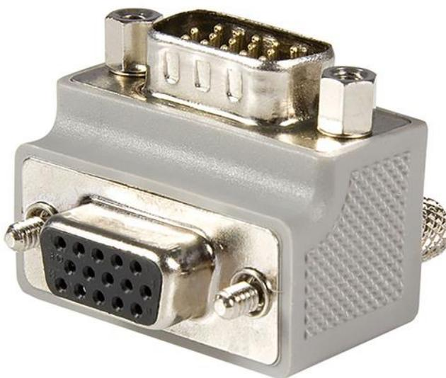
Dieser rechtwinklige VGA-zu-VGA-Kabel-Adapter Typ 2 verfügt über einen rechtwinkligen VGA-Steckverbinder und eine Standard-VGA-Buchse - damit können Sie das Kabel an eine VGA-Buchse anschließen, auch wenn der Platz rund um den VGA-Port begrenzt ist.
