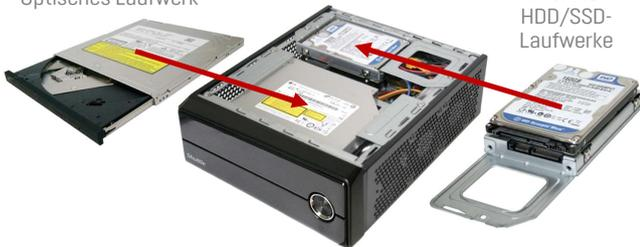
Zwei 2,5" HDD/SSD-Laufwerke
