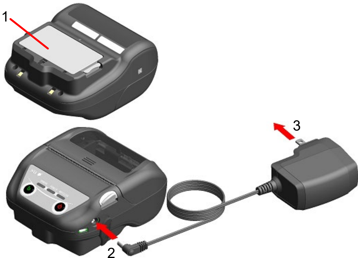
Abbildung 16-2 Aufladen im ausgeschalteten Lademodus mit dem Netzteil
