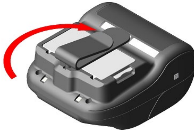
Abbildung 15-4 Anbringung des Gürtelclips (4)
