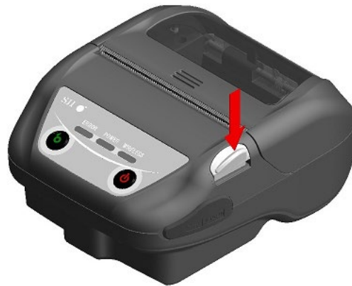
Abbildung 9-1 Taste zum Öffnen der Papierabdeckung
