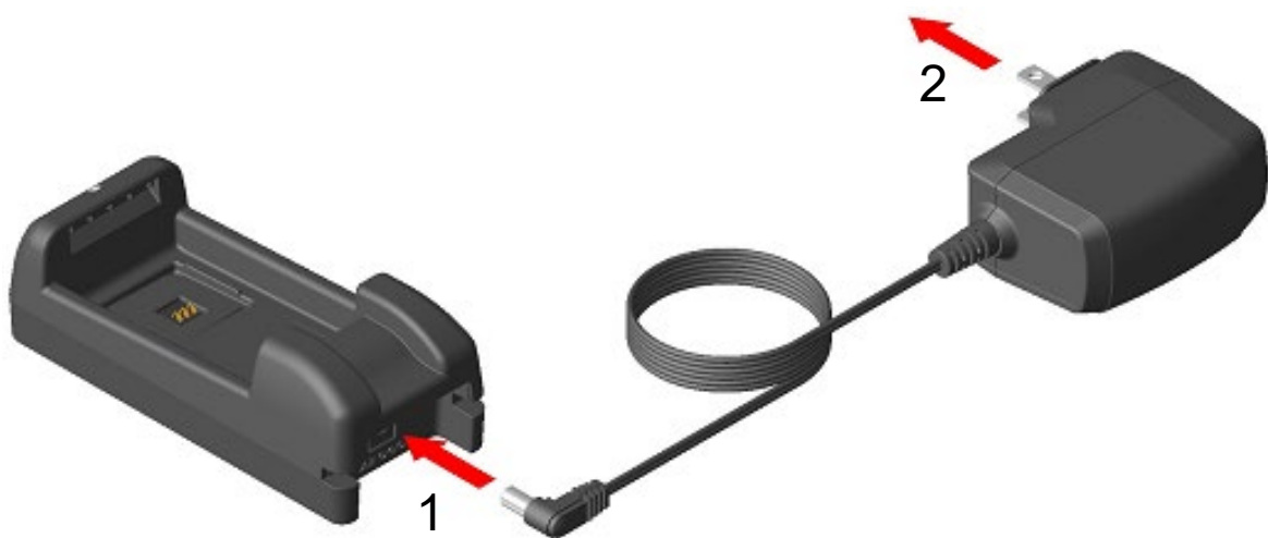
Abbildung 19-2 Verbinden des Akkuladegeräts mit dem Netzteil
