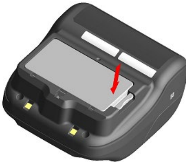
Abbildung 8-3 Einlegen des Akkupakets (2)
