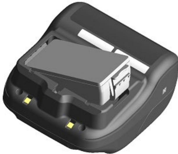
Abbildung 8-2 Einlegen des Akkupakets (1)
