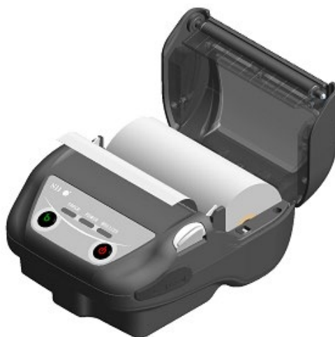
Abbildung 9-3 Einsetzen des Thermopapiers
