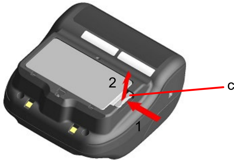
Abbildung 8-4 Entnehmen des Akkupakets
