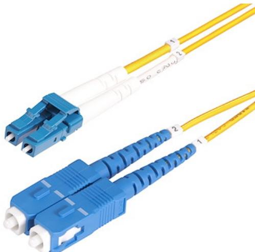
Le câble de raccordement fibre optique monomode duplex OS2 LC vers SC facilite la connectivité sur les réseaux 100G. Il prend en charge la Multiplexage en Division de Longueur d'Onde Grossière (CWDM) sur une plage étendue de longueurs d'onde de 1260 à 1625 nm, améliorant l'isolation des canaux pour une force de signal optimale sur de longues distances.
