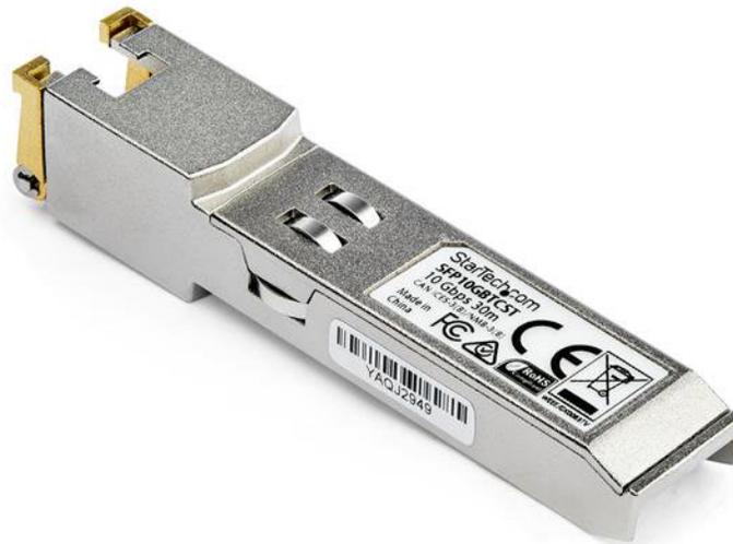
Il prodotto SFP10GBTCST è un modulo ricetrasmittitore in rame compatibile con Cisco, progettato, programmato e testato per operare con switch e router a marchio Cisco®. Offre un'affidabile connettività da 10 GbE tramite cablaggi in rame per le reti compatibili con 10BASE-T, a una distanza massima di 30 m.
