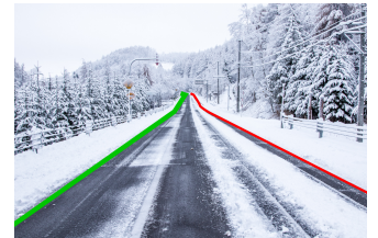
Virtuelle Begrenzungen Beispiel einer virtuellen Linie, die den Überwachungsbereich einer Straße eingrenzt.
