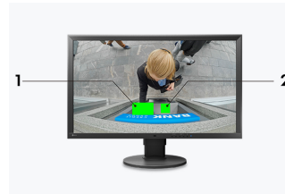
Maskierung Beispiel für die Datenschutzmaskierung an einem Geldautomaten: 1. verdeckte Bankkarte, 2. verdecktes Tastenfeld
