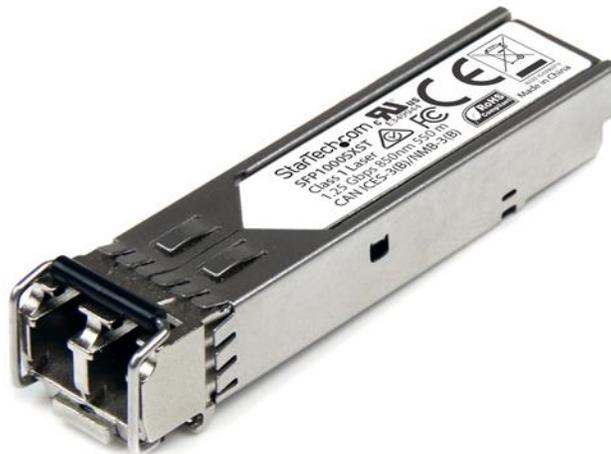
Der SFP1000SXST ist ein MSA-konformer SFP-Transceiver, der speziell für die Arbeit mit 1000BASE-SX-kompatiblen MSA-Switches und -Routern entwickelt, programmiert und getestet wurde. Das SFP-Transceiver-Modul unterstützt eine maximale Entfernung von bis zu 550 m und bietet zuverlässige 1-GbE-Konnektivität über Glasfaserkabel.
