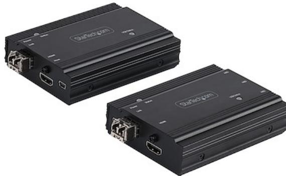
Este kit extensor KVM HDMI le permite utilizar un teclado, un ratón y un monitor para controlar a distancia cualquier ordenador a través de una conexión de fibra punto a punto. Cuando se combina con un conmutador KVM, el extensor de consola KVM puede utilizarse con varios ordenadores. El alargador cuenta con tres puertos USB HID que le permiten conectar dispositivos HID, como el teclado y el ratón.
