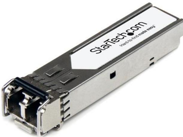
El modelo J9152D-ST es un módulo transceptor SFP+ por fibra óptica compatible con el modelo J9152D de HP diseñado, programado y probado para su funcionamiento con routers y switches de la marca HP®. Ofrece conectividad confiable a 10 GbE, a través de cable de fibra óptica, para redes compatibles con 10GBase-LRM, a una distancia máxima de hasta 200 m.
