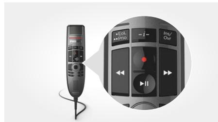
Bedienung per Drucktasten
