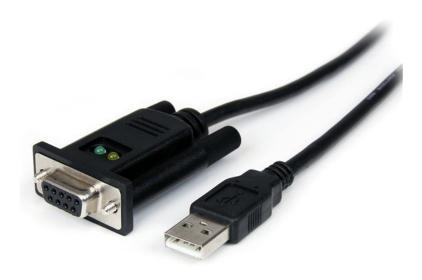
Das FTDI USB-auf-Nullmodem-Serielle-Adapterkabel (1 Port) ICUSB232FTN konvertiert einen verfügbaren USB 1.1 oder 2.0-Port in einen RS232-Nullmodem-Seriellen-DB9-Port, sodass DCE/DTE-Konflikte direkt gelöst werden, ohne dass zusätzliche kreuzverdrahtete serielle Kabel oder Adapter erforderlich sind.
