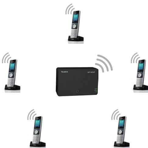
Los sistemas W56P pueden expandirse hasta un total de 5 dispositivos telefónicos inalámbricos, añadiendo los dispositivos telefónicos inalámbricos W56H o W52H
