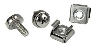
Diese 100-Stück-Packung mit M5 Montageschrauben und Käfigmuttern für Serverracks und -schränke ist das ideale Zubehör für den sicheren Einbau von Servern, Netzwerkgeräten, AV-Geräten und anderen Rackmontage-Geräten in Ihrem Speicherschrank oder Serverrack. Jede Packung enthält ein Einbauwerkzeug für Käfigmuttern, sodass Sie jede Käfigmutter schnell und einfach anbringen können.
