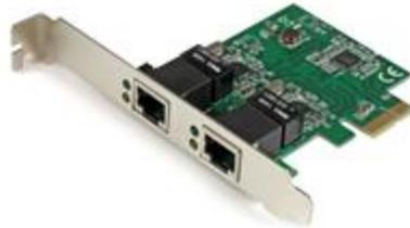
Mit der PCI Express Dual Port-Gigabit-Netzwerkkarte ST1000SPEXD4 können Sie einem Client, einem Server oder einer Workstation über einen einzigen PCI-Steckplatz zwei Gigabit-Ethernet-Ports hinzufügen. Jeder Port bietet 10/100/1000 Mbit/s Ethernet und ist vollständig mit den IEEE 802.3/u/ab-Standards kompatibel.
