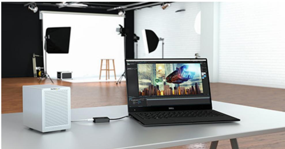
Dado que este adaptador es retrocompatible, es posible conectar dispositivos Thunderbolt de primera generación a velocidades de 10 Gbps. En el caso de dispositivos Thunderbolt 2, es posible la conexión a 20 Gbps. El adaptador es compatible con las transferencias de datos bidireccionales y la alimentación simultánea de dispositivos con alimentación por bus.
