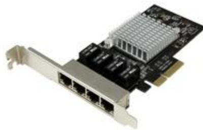
He aquí una manera fiable y económica de agregar 4 puertos Ethernet Gigabit de alto rendimiento a su servidor u ordenador de sobremesa, a través de una ranura PCI Express.
