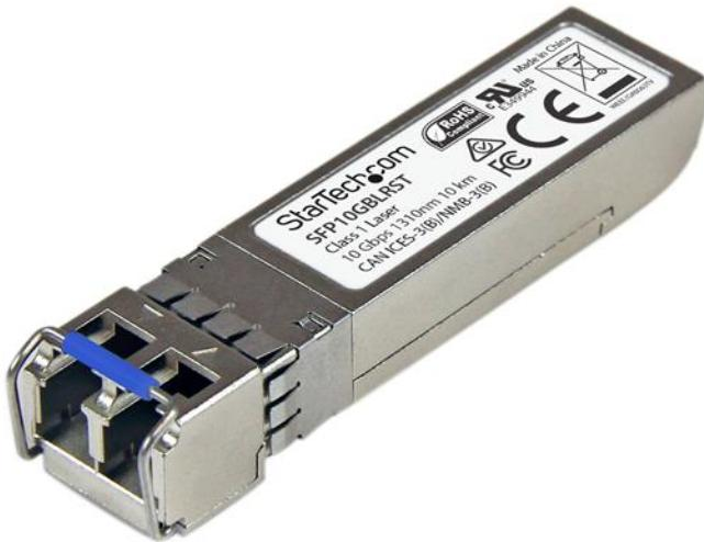
Le SFP10GBLRST est un transceiver SFP à fibre optique conforme aux normes MSA qui est conçu, programmé et testé pour fonctionner avec des commutateurs et routeurs 10GBASE-LR conformes aux normes MSA. Le module de transceiver SFP+ prend en charge une distance maximale de 10 km et fournit une connectivité 10 GbE fiable via un câblage de fibre optique.
