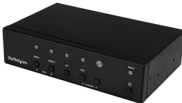
Ce commutateur et convertisseur à multiples entrées vous permet de connecter vos sources audio/vidéo DisplayPort (DP), HDMI® et VGA à un écran ou vidéoprojecteur HDMI. Ce commutateur vous permet de commuter automatiquement ou manuellement entre vos sources vidéo et comporte la conversion de signaux intégrée, ce qui élimine le coût et les tracas de devoir utiliser des adaptateurs supplémentaires au nom de la compatibilité.
