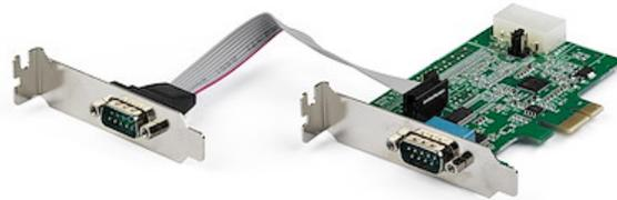
Con questa scheda adattatore seriale RS232 è possibile aggiungere due porte seriali RS232 (DB9) al computer tramite uno slot PCI Express (PCIe), consentendo l'interazione con dispositivi seriali come lettori per schede, stampanti, tastierini PIN e modem, a velocità fino a 921,4 Kbps.
