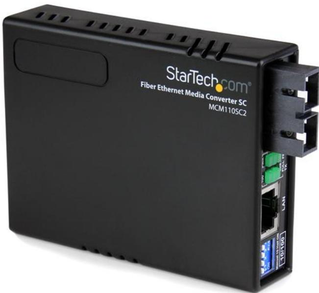
El Conversor de Medios Ethernet 10/100 a Fibra Multimodo (SC, 2 km), MCM110SC2EU permite crear un enlace Ethernet-fibra eficaz y económico que convierte señales Ethernet 10Base-T o 100Base-Tx en señales ópticas 100Base-Fx, y viceversa para extender una conexión de red Ethernet a través de un backbone de fibra Multimodo terminada en SC.).
