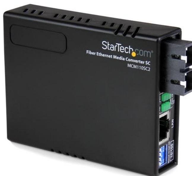
Le convertisseur Ethernet fibre optique multimode 10/100 MCM110SC2EU (SC, 2 km) crée une liaison Ethernet-fibre optique économique, qui convertit de façon homogène vers/depus des signaux Ethernet 10Base-T ou 100Base-Tx et optiques 100Base-Fx pour l'extension d'une connexion réseau Ethernet sur une infrastructure en fibre optique multimode SC.
