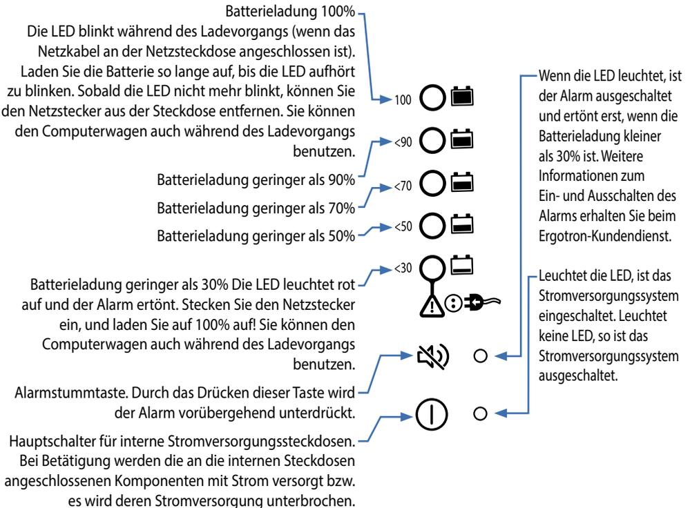
**HINWEIS: Wird der Computerwagen häufig bei einem Ladestatus unter 30% verwendet, verkürzt dies die Lebensdauer der Batterie erheblich.**
