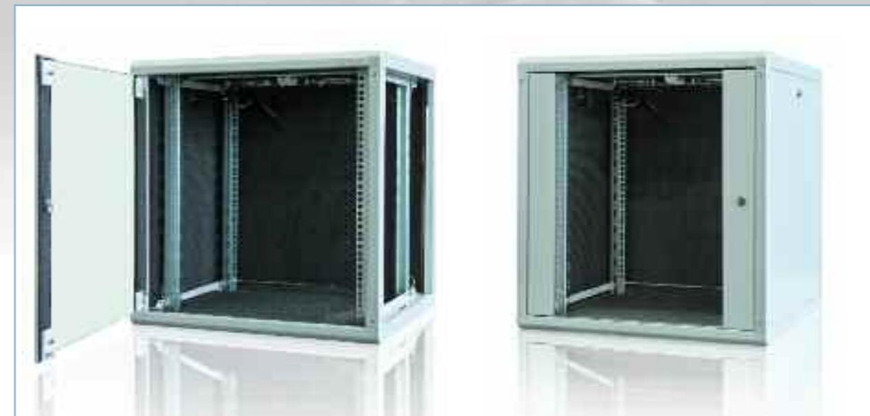
■ Der 19" Wandschrank Akustik bietet Lärmschutz bei lauten Switches und anderen IT-Komponenten, die in Wandverteilern untergebracht werden sollen. Zwei sehr leise Ventilatoren sorgen für ausreichende Belüftung.
