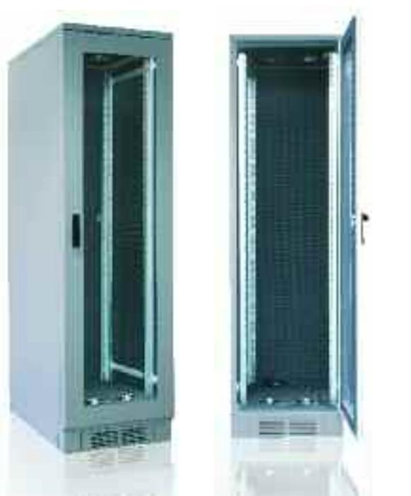
Mit 42 Höheneinheiten gibt es den Silent 42 in den Breiten 600 und 800 mm und den Tiefen 600, 800, 900, 1000 und 1200 mm. In der Standardausführung werden zwei frontseitig einblasende Ventilatoren im Bodenmodul und zwei ausblasende im Dachmodul verbaut. Eine Erweiterung der Ventilatoren im Dach- und Bodenmodul sowie in der Rücktür ist möglich. Der Silent 42 wird in der Standard-Version Sockel mit Nivellierfüßen bestückt. Doppellenklaufrollen sind optional möglich.
