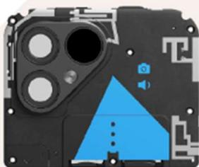
In dieser Einheit befinden sich der Flugzeitsensor, der Kamerablitz sowie separate SD- und SIM-Kartensteckplätze.
