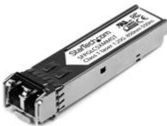
Le module de transcepteur SFP à fibre optique MM LC Gigabit compatible Cisco® SFPGLCSXMMST de 550 m a été conçu pour être conforme aux normes MSA (Multi-Sourcing Agreement) et offrir un moyen économique pour ajouter, remplacer ou mettre à niveau un port multimode LC sur votre équipement réseau ou convertisseur Gigabit Ethernet à fibre optique.
