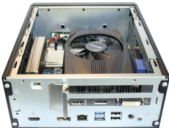
Shuttle XPC slim Barebone XH510G2 mit eingebauter leistungsstarker Grafikkarte
