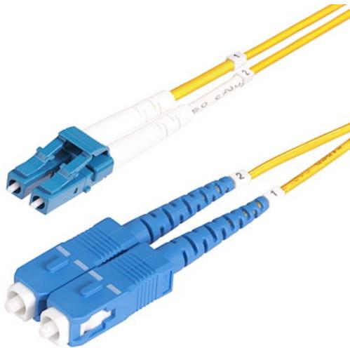
Das OS2 LC auf SC Single Mode Duplex Glasfaser-Patchkabel erleichtert die Konnektivität in 100G-Netzwerken. Es unterstützt Coarse Wavelength Division Multiplexing (CWDM) über einen erweiterten Wellenlängenbereich von 1260-1625 nm und verbessert die Kanalisierung für eine optimale Signalstärke über große Entfernung.
