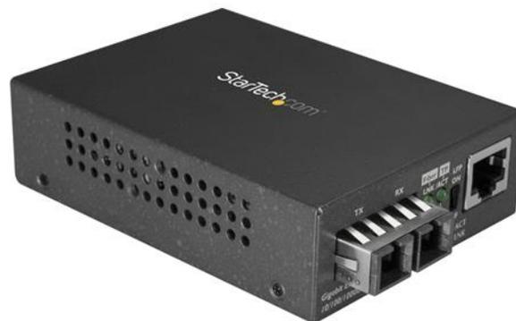
Ce convertisseur de média fibre optique étend un réseau Gigabit Ethernet (1 000 Mb/s) jusqu'à 550 m sur fibre optique multimode sur les réseaux 1000BASE-SX.
