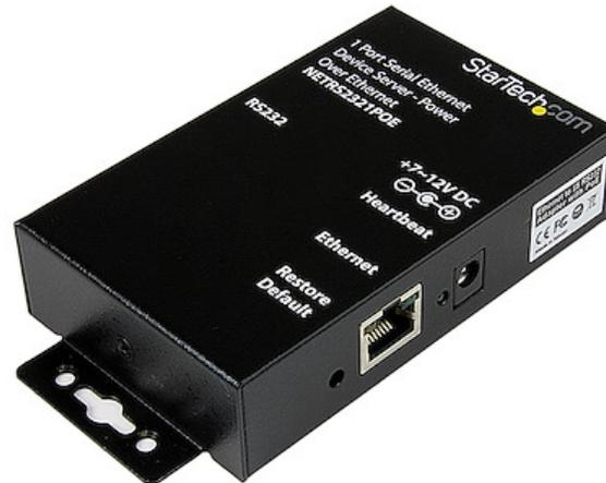
Il convertitore seriale Ethernet RS-232 a 1 porta NETRS2321POE - PoE (Power Over Ethernet) consente di installare dispositivi RS-232 in qualsiasi punto della rete TCP/IP Ethernet WAN/LAN e accedervi come se fossero accanto all'utente, persino tramite Internet!
