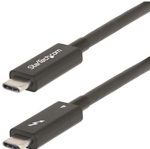
Das 2m Active Thunderbolt™ 4 Kabel ermöglicht volle Thunderbolt™ 4 Fähigkeiten und übertrifft passive Kabel über 91cm Länge. Ein aktiver integrierter Chipsatz reduziert die Signalverluste für eine konsistente 40Gbps Ausgabe bei Entferungen von bis zu 2m, während passive Kabel aufgrund von Signalverlusten eine begrenzte Leistung über 91cm hinaus liefern.
