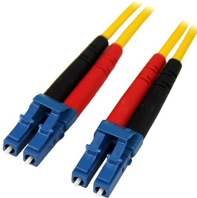
El cable de fibra óptica (4 m), LC a LC, dúplex de modo único, modelo SMFIBLCLC4, con fibra óptica de 9/125 micrones, permite transmisiones de datos a alta velocidad y alto ancho de banda, a través de redes Gigabit Ethernet y canal de fibra, con soporte para aplicaciones dúplex de modo único.
