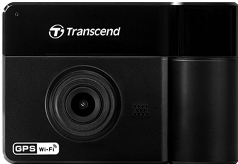
Die DrivePro 550 von Transcend ist eine Dash-Kamera mit zwei Objektiven, die sowohl Fahrern als auch Passagieren optimalen Schutz bietet. Das vordere Objektiv verfügt über einen Exmor - Bildsensor und ein weites Sichtfeld für die Aufnahme kristallklarer Full HD 1080P-Videos, während das um 180° drehbare hintere Objektiv mit vier Infrarot-LEDs ausgestattet ist um scharfe Videoaufnahmen im Auto bei Nacht und bei schlechten Lichtverhältnissen zu ermöglichen.
