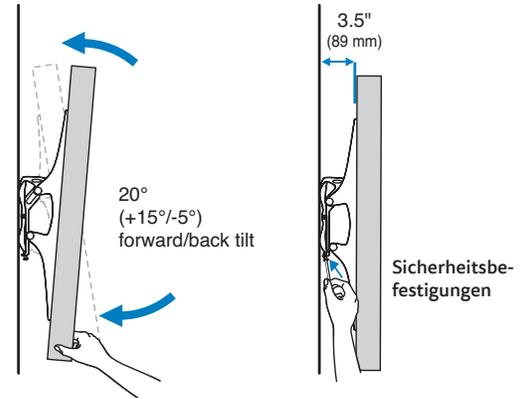
Bildschirmwinkel kann mit Kipp-Sperr-Funktion justiert werden
